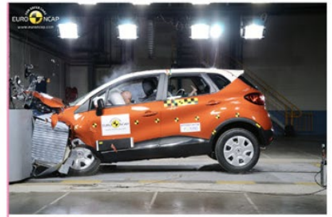
FIG. 1 Lors de l'impact, la déformation est d'autant plus importante que le véhicule possède une énergie cinétique importante.
